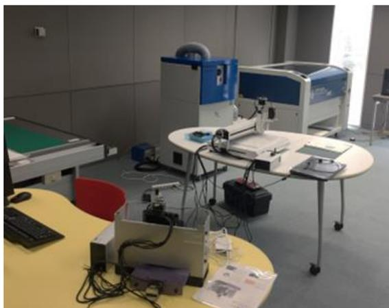
プロトタイプ開発ゾーンには、研究をいち早く形にする為のデジタル機材として、大型のレーザー加工機（EPILOGLASER FUSION M2）、カッティングプロッタ（GRAPHTEC FCX2000）、デスクトップ型CNCフライス（KitMill SR200 / CIP100）などを設置しています。
