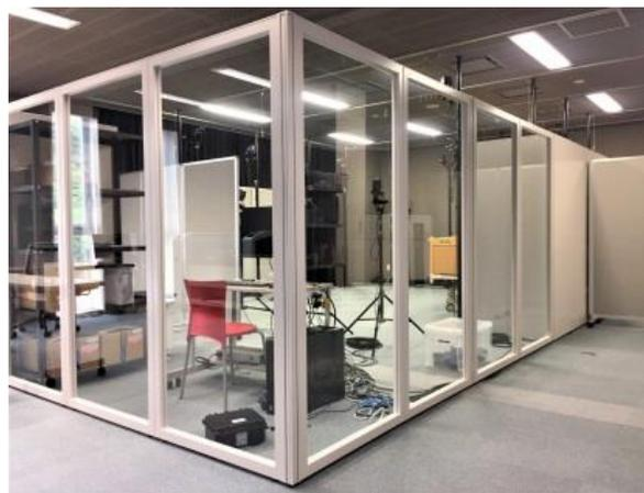
体験・評価ゾーンでは、計測・評価機材として、筋骨格モデル動作解析ソフトウェア（nMotion Musculous）、ワイヤレス筋電位信号計測システム（DELSYS）、装着式モーションキャプチャ（NOITOM PERCEPTION NEURON）、工学マーカ式モーションキャプチャ（MAC 3D System MotionAnarisy Kestrel Camera）、装着型眼球運動計測装置（ナック アイマークレコーダー EMR-9）などを設置し、多角度から、迅速かつ正確な評価検証が可能となっています。
